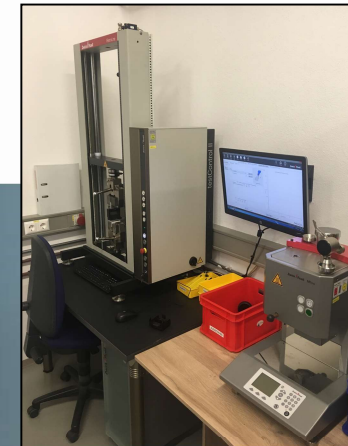
Zugprüfmaschine und Schmelzindex- Prüfgerät von Zwick/Roell
