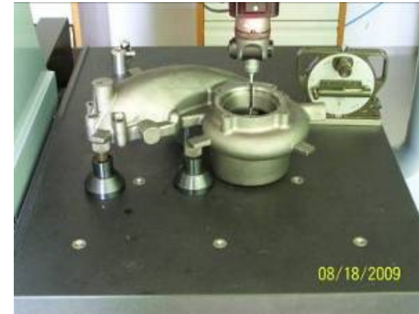
messen eines fertig gefrästen Turboladergehäuse (Borg Warner)
