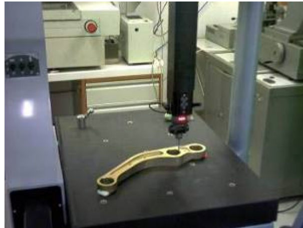
messen eines Querlenker Audi A 8 (Sonderausführung in 42CrMoV4)
