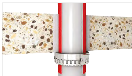
schallgedämmte Abwasserrohre mit PE-Schallschutzschlauch
