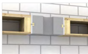
Holzbalkendecke ohne Unterdecke
