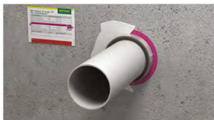
Verschluss von Rest- bzw. Ringspalten oder Durchbrüchen mit Tangit FP 550 2K-Brandschutz- Schaum. Voraussetzung: Ringspalt nimmt min. 40 % des Volumens der Kernbohrung ein.
