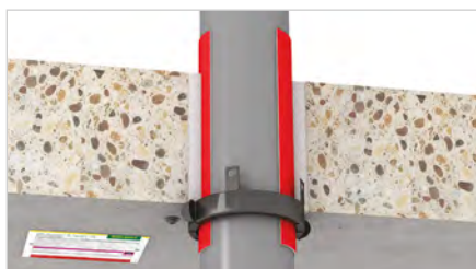
Halteflaschen einge- mörtelt (90° umgebogen)
