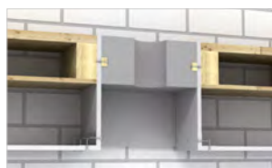
Holzbalkendecke mit Unterdecke
