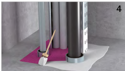
Tangit FP 800 Brandschutz-Anstrich oberhalb des Deckenschotts auf den Schaum und 3 cm des angrenzenden Bereichs, bzw. 15 cm auf die Kabel(-trasse) auftragen.
