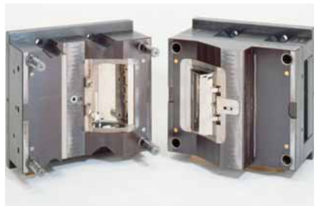
1-fach Spritzwerkzeug hochglanzpoliert
