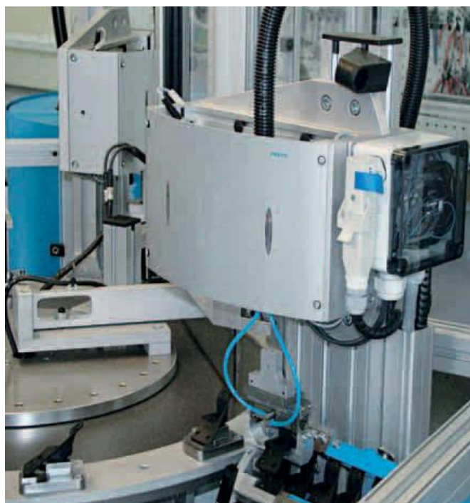
▲ Schnellstes pneumatisches Handling am Markt: Erhöhte Ausstoßraten von bis zu 100 Teilen pro Minute und 20% geringere Taktzeiten machen das HSP zum Spezialisten, wenn es ums Handhaben von Kleinteilen mit typischen Werkstückmassen unter 100 g geht.
