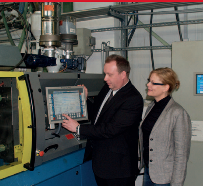
Bernd Fischer, der Bereichsleiter Anwendungstechnik und Service bei Boy, und Ulrike Steiner verfolgen die Prozesskennzahlen und Energieverbrauchswerte auf der Maschinensteuerung Procan Alpha. Der große Kasten mit Bildschirm im Hintergrund beherbergt eine Steuerung mit einer selbst entwickelten Softwarelösung (Fotos: Doriat)
