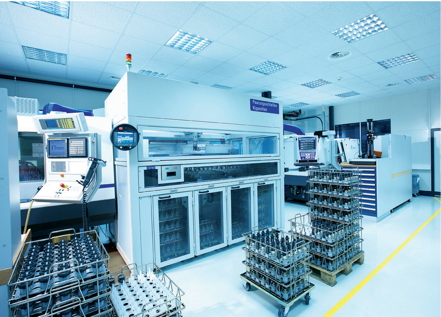
Klimatisierte Produktionshalle für vollautomatisches Paarungsschleifen
