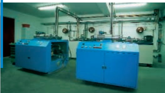
Hochdruckpumpen – bis 4000 bar
