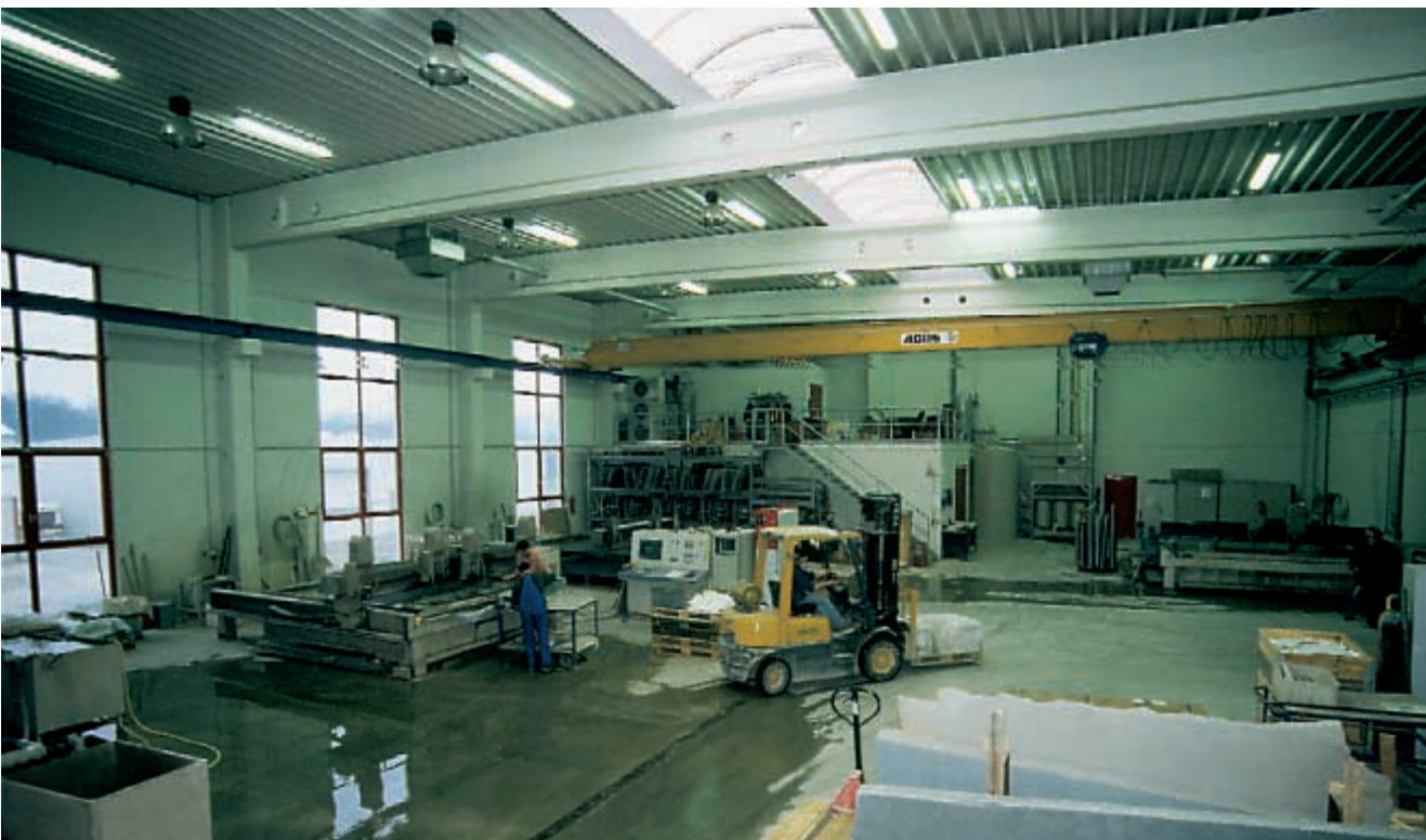
Produktionsbereich mit LKW-Zufahrt. Be- und Entladung mit 5t-Brückenkran
