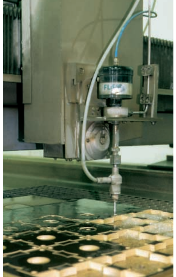
Präzisionsteile – Wasserstrahl geschnitten
