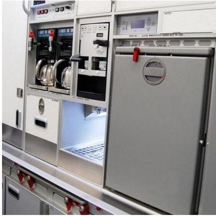
Tür eines Dampfgarofens einer Flugzeugborküche. Der robuste Lack ist sehr stoßfest. Hier sind Schaumguss und Lackierung gut aufeinander abgestimmt.
