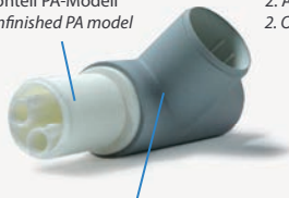
1. Arbeitsgang: Lackieren mit Spritzfüller und schleifen 1. Operation: Lacquer with spray-on filler and polish
