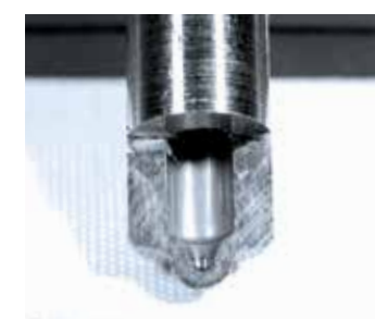
DE/ Verrunden der Verzahnung EN/ Rounding the gearing
