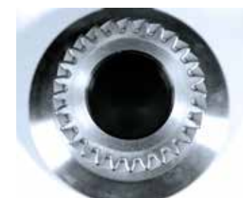
DE/ Verrunden der Verzahnung EN/ Rounding the gearing
