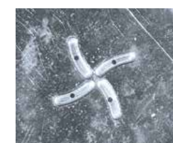
DE/ Kombinierte Laserbearbeitung - Bohren und Flächenabtrag EN/ Combined laser machining - drilling and surface removal
