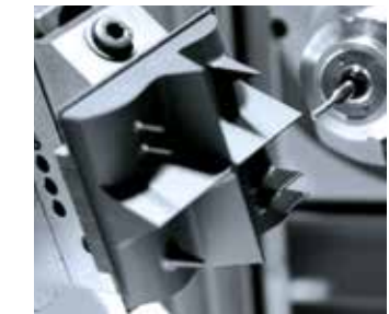
DE/ Graphitelektrode 5-Achsen-Fräsen EN/ Graphite electrode 5-axes milling
