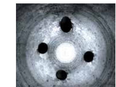
DE/ Laser-Bohrungen ø ca. 150 µm EN/ Laser holes ø approx. 150 µm
