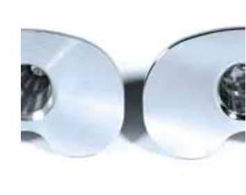
DE/ Bearbeitung, Polieren und Herstellen der ebenen Fläche mit PECM EN/ Machining, polishing and producing the flat surface with PECM
