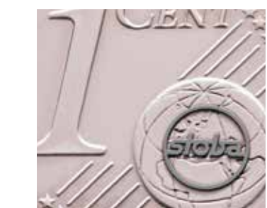
DE/ Laserschneiden des stoba-Namenszuges EN/ Laser cutting of the stoba signature
