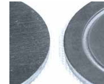
DE/ Mit ECM hergestellte Membrannut erhöht die Lebenszeit des Bauteils EN/ Membrane groove produced with ECM increases the lifetime of the component
