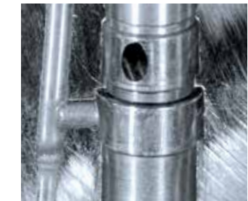
DE/ Verbindungsbohrung mit ECM hergestellt EN/ Connecting bore produced with ECM
