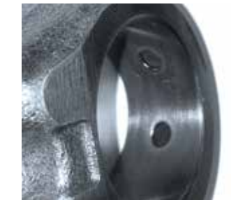
DE/ Bohrung mit ECM grat- und riefenfrei fertiggestellt EN/ Bore produced with ECM burr and groove free
