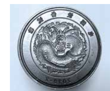
DE/ PECM-Bearbeiten der Münzstruktur EN/ PECM machining the coin structure
