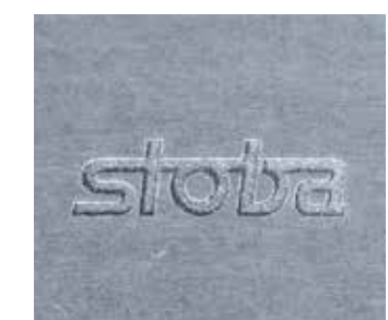
DE/ Laserbeschriften einer Keramikplatte EN/ Laser marking of a ceramic plate
