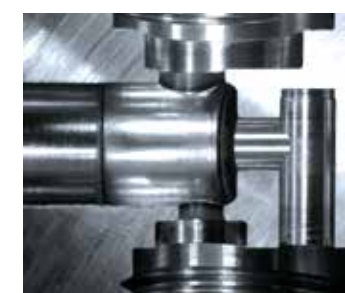
DE/ Entgraten und Verrunden EN/ Deburring and rounding
