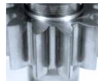
DE/ Verrunden der Zahnenden EN/ Rounding gear ends
