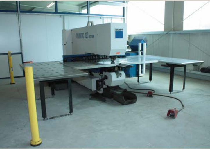
CNC Stanznippelmaschine Stanz- und Nippelarbeiten, Umformen und Prägen max. Blechstärke 4mm
