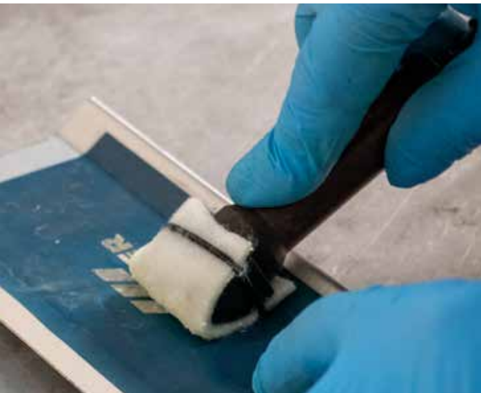
Elektrolytisches Beizen / Signieren
