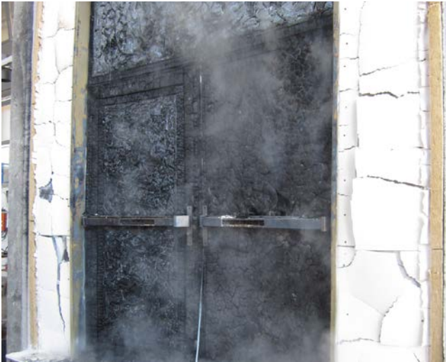
Abb. 1: Systemprüfung beim EMPA – Beflammung einer Holztüre
