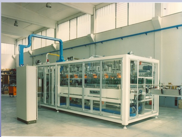
Macchina autom. per l'imballaggio di bottiglie di vetro in confezioni di cartone/ Bottling plant/Automatisierte Maschine zur Verpackung von Glasflaschen in Papierkartons
