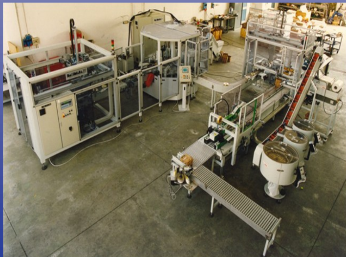
Linea automatica di assemblaggio ruote per cancelli e portoni industriali Automatisierte Montagelinie von Rädern für Gitter- und Industrie-Tore
