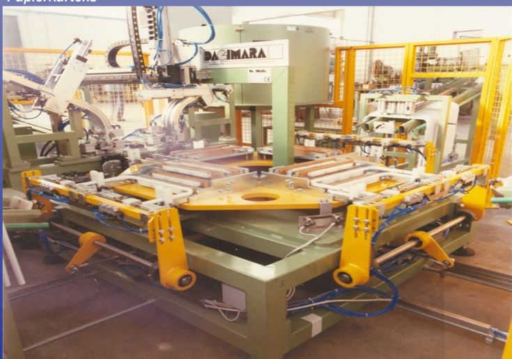
Macchina automatica per il montaggio di sedie in tubo leggero Automatisierte Maschine zur Montage von Stühlen aus Leichtrohr
