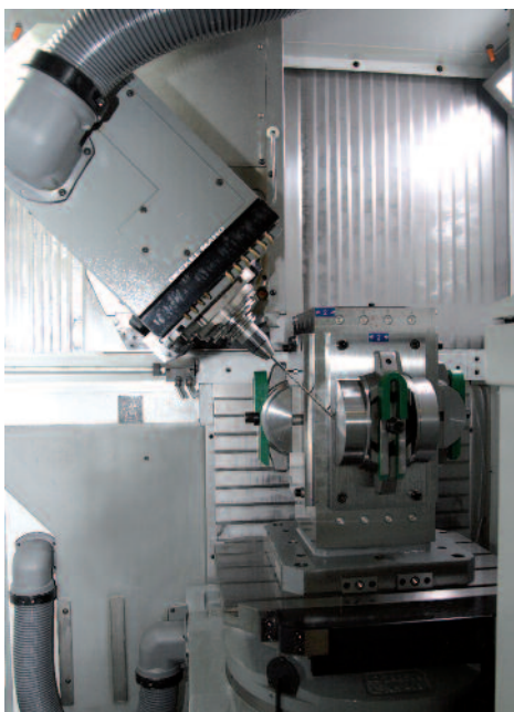
5-Achs-Bearbeitungszentrum mit Verfahrwerkzeug bis 2500 mm.
