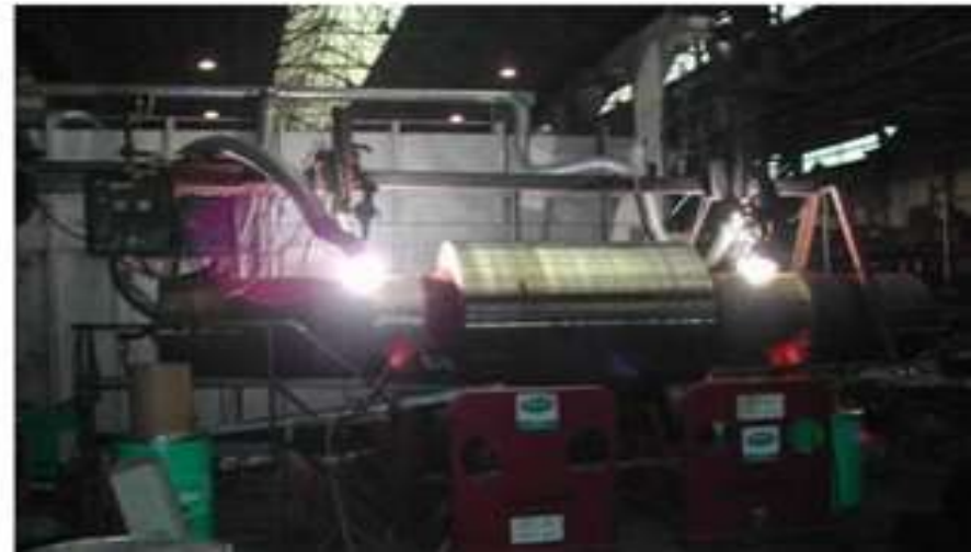
Schweißen der Lagersitze von Arbeitswalzen Stückgewicht : 36.000kg
