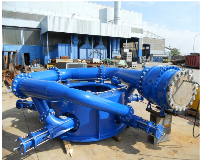
Cassa Kaplan con condotto – Kaplan housing with pipe – Kaplangehäuse mit Leitung
