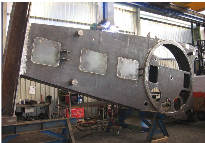
Basamento torretta -Turret base – Grundrahmen Turm
