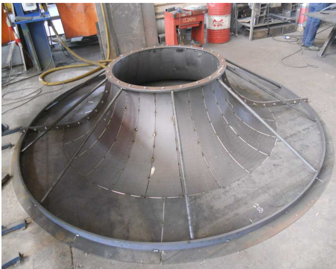
Scarico - outlet - Ablauf
