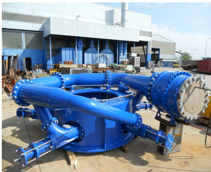
Cassa Kaplan con condotto – Kaplan housing with pipe – Kaplangehäuse mit Leitung
