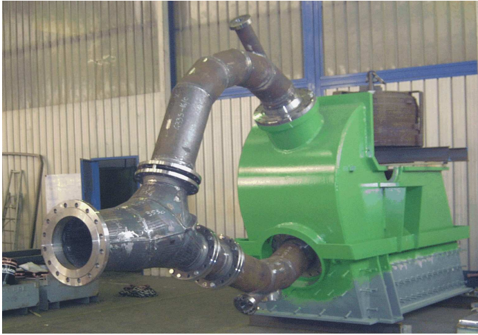
Cassa Pelton con condotto – Pelton housing with pipe – Peltongehäuse mit Leitung
