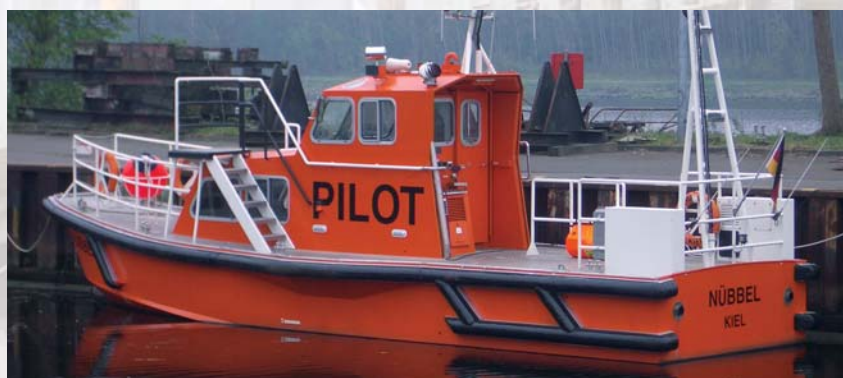
Individuell gefertigte Scheuerleiste aus PE-Schaum mit PUR-Außenhaut Individually manufactured rubbing strip of PE foam with PUR skin
