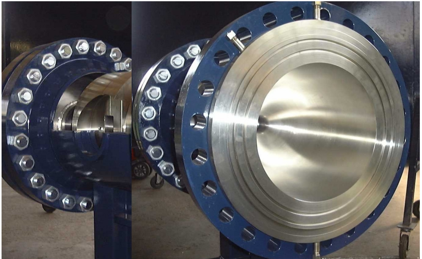
Abbildung: Durchflußprüfnormal 20" 600# für PTB Braunschweig 2004
