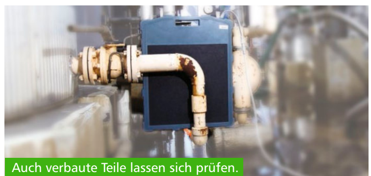
Untersuchen einer Schweißnaht mit Spezialfilter
