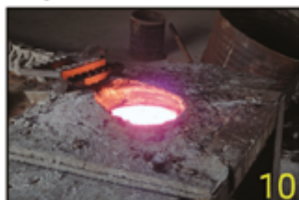
Fusione metallo e colata nel grappolo Melting
