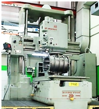
n.1 Vertikalbohrwerk SIP GENEVOISE Modell HYDROPTIC 7 mit verlängerter Z-Achse, generalüberholt. Kippbarer Teilkopf GENEVOISE PI 450 + Drehbarer Teilkopf ROTOPTIC Hübe: X 1400 Y 1000 Z 1800
