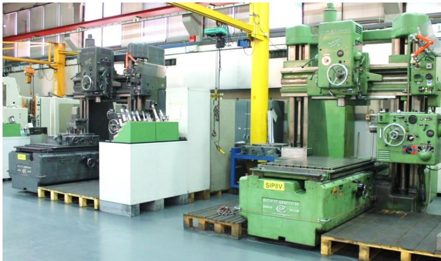
n.2 Horizontal/Vertikal-Bohrwerke SIP GENEVOISE Modell HYDROPTIC 8 mit zwei Arbeitsköpfen, generalüberholt. Schwenkbarer Teilkopf GENEVOISE PI 450 + Drehbarer Teilkopf ROTOPTIC Hübe: X 1400 Y 1000 Z 900
