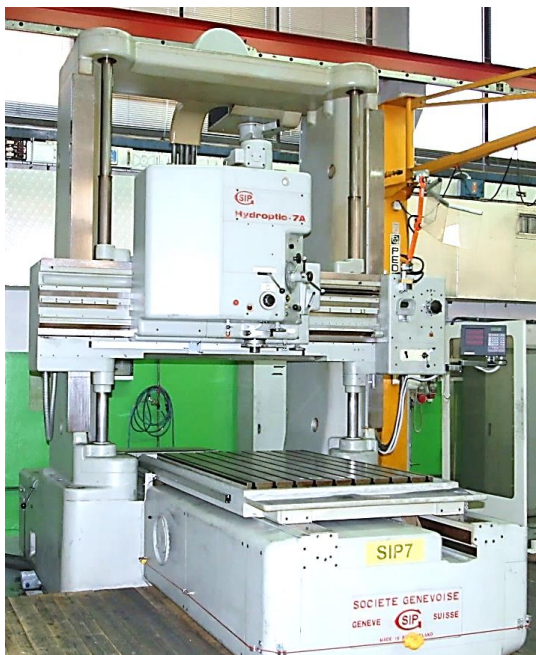
n.1 Vertikalbohrwerk SIP GENEVOISE Modell HYDROPTIC 7 mit verlängerter Z-Achse, generalüberholt. Kippbarer Teilkopf GENEVOISE PI 450 + Drehbarer Teilkopf ROTOPTIC Hübe: X 1400 Y 1000 Z 1800
