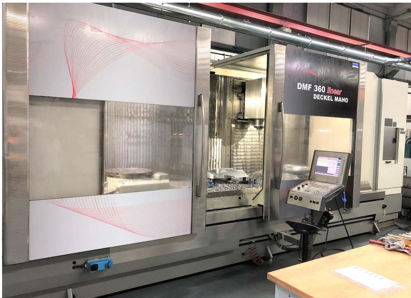
n. 1 Centro di lavoro a montante mobile DECKEL-MAHO DMF 360 LINEAR ISO 50, magazzino utensili 80 posti, testa a fresare brandeggiabile automatica indexata 1°, rapidi X/Y/Z 100/60/60, controllo CNC SIEMENS 840D, tavola in continuo (4° asse) orizzontale-verticale. Corse: X 3600 Y 920 Z 820
