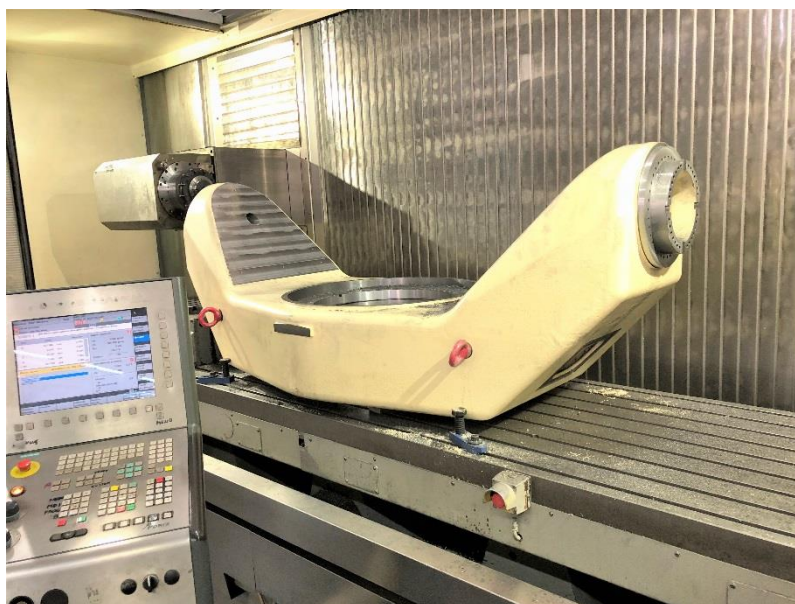
n. 1 Centro di lavoro a montante mobile DECKEL-MAHO DMF 360 LINEAR ISO 50, magazzino utensili 80 posti, testa a fresare brandeggiabile automatica indexata 1°, rapidi X/Y/Z 100/60/60, controllo CNC SIEMENS 840D, tavola in continuo (4° asse) orizzontale-verticale. Corse: X 3600 Y 920 Z 820
