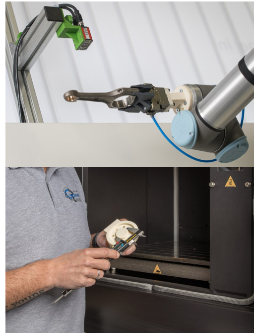
Bauteilvermessung von Hand oder roboter- gestützt
