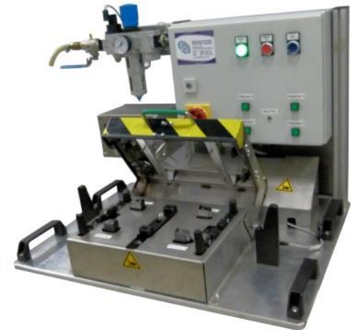
Montagevorrichtung Blechmutter an Kennzeichenträger
