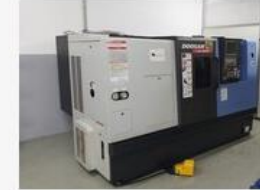
Doosan Lynx 220LM Hersteller: Doosan Steuerung: Fanuc Baujahr: 2016 Technologien: Drehen
