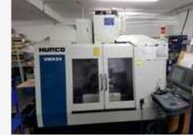
Hurco 24 Hersteller: Hurco Steuerung: WinMax Baujahr: 2003 Technologien: Formfräsen (3 D)
