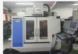
HURCO VM1 Hersteller: Hurco Steuerung: WinMax Baujahr: 2008 Technologien: Formfräsen (3 D)
