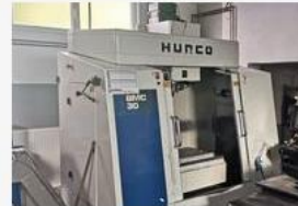
Hurco 30 Hersteller: Hurco Steuerung: Ultimac-CNC Baujahr: 1996 Technologien: Formfräsen (3 D)
