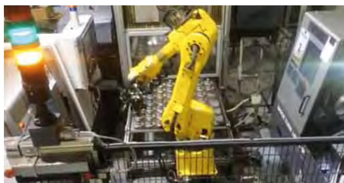
- ISOLA DI TORNITURA, FORATURA E FRESATURA PERNI STERZO - TURNING, DRILLING AND MILLING CELL FOR STEERING PINS
