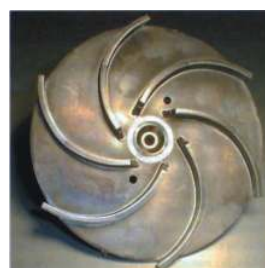
Pumpenlaufrad mit 3D-Schweißführung
