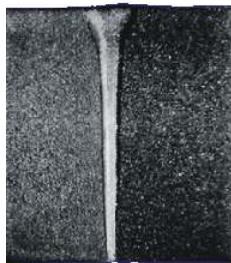
Strahlschweißen I-Naht 30 mm kaum Schrumpfung
