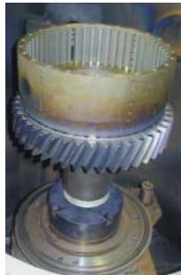
Zahnwelle für einen Planetenträger, final verschweißt
