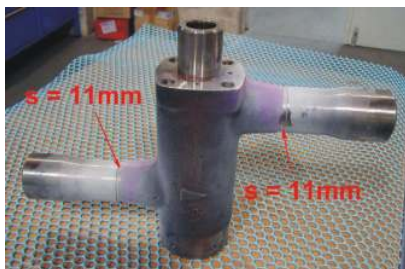
Elektronenstrahlschweißung von Stützen aus 13CrMo44
