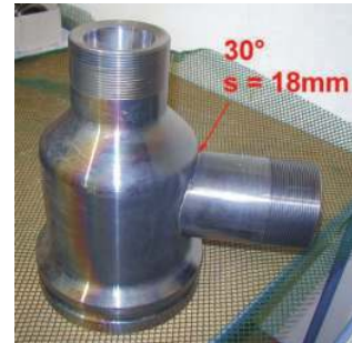
Eckventilgehäuse mit 3D-Satteltkontur 30 mm Wandstärke
