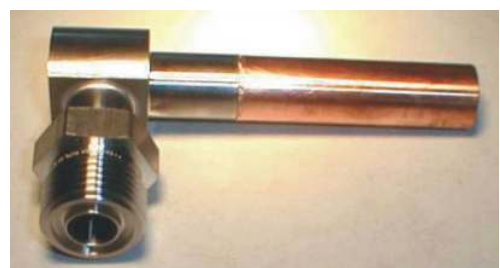
Wasseranschluss als Kupfer-Stahl-Verbindung, elektronenstrahlgewweißst
