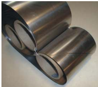
Elektronenstrahlschweißung von Förderbändern, 0,2 mm
