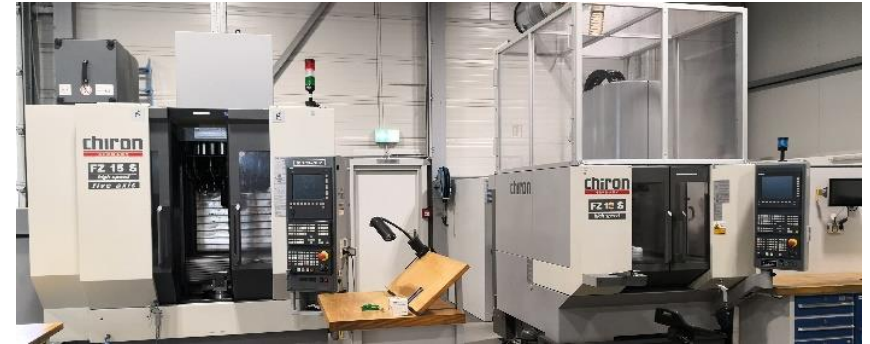
CNC Fräszentren Chiron FZ 15 (5-Achs) und FZ 12 (3-Achs)
