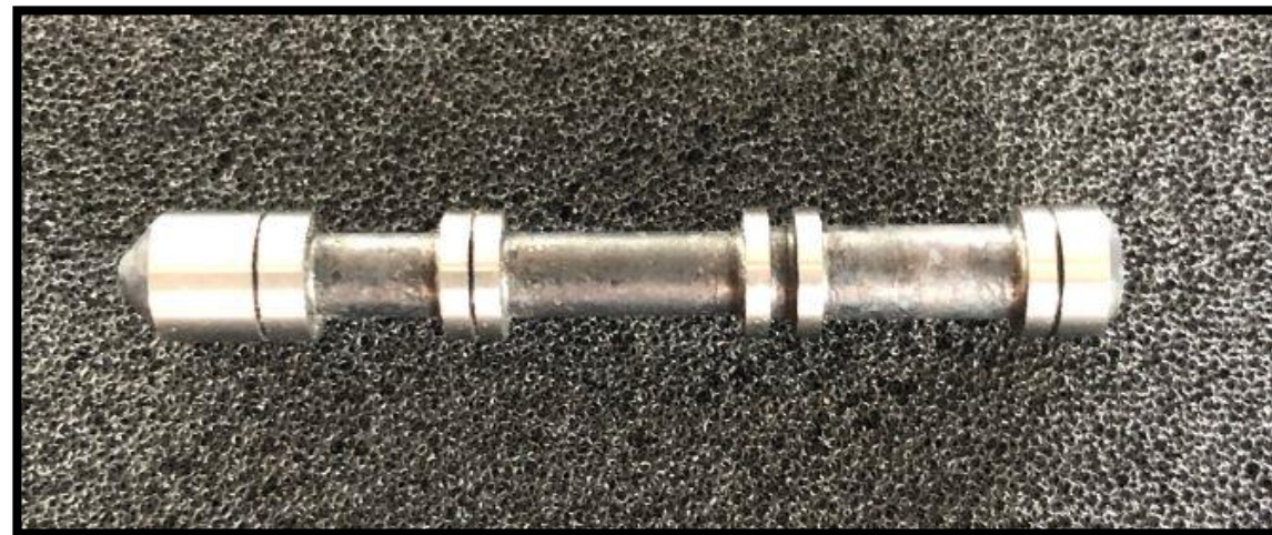
Kolbenstange aus Stahl (Einsatzgehärtet mit 65 HRC) (Anschließende Schleifbearbeitung auf 2µm Genauigkeit)
