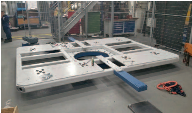
SOPAP Flaches Behälterwechselsystem auf Basis TXR 1100, hier für 2 Behälter
