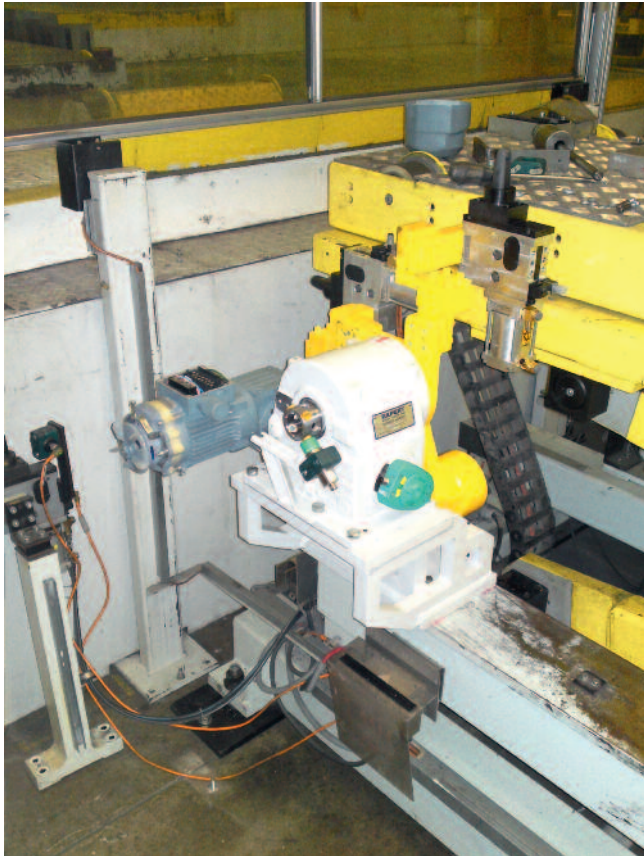
EXPERT „Windmühlen“ Globoidgetriebe mit Präzisionsverriegelung zum Positionieren der Bodenspanntechnik an Transportaufgaben
