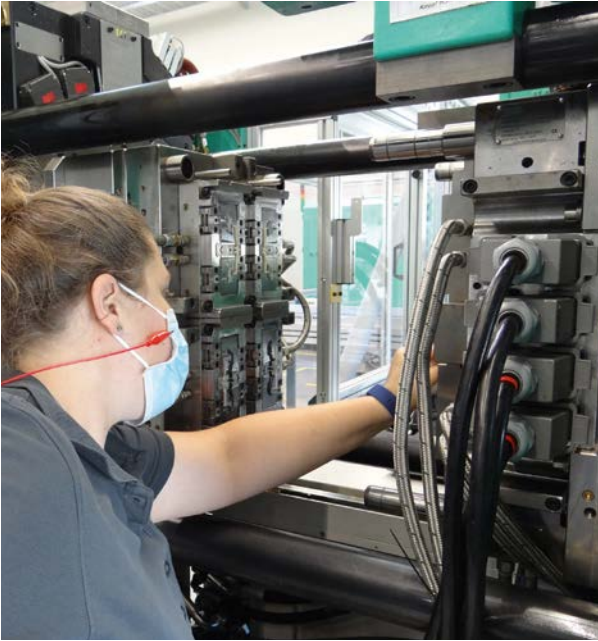
Einmal täglich wird die hochglanzpolierte Kavität von filmischen Rückständen gereinigt.
