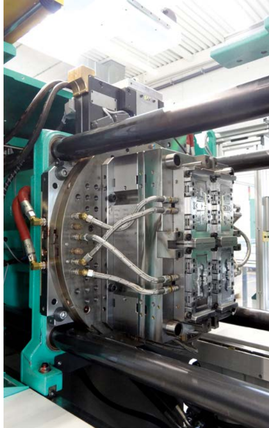
4+4-Werkzeug einer 3K-Taste mit individuellem Drehteller in flacher Bauweise sowie verschleißarmer und korrosionsbeständiger Medienübergabe.
