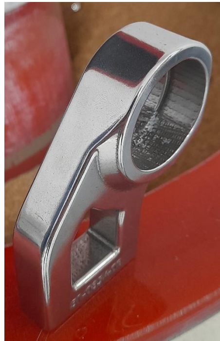
6: Aluminiumbauteil nach Gleitschleifen
