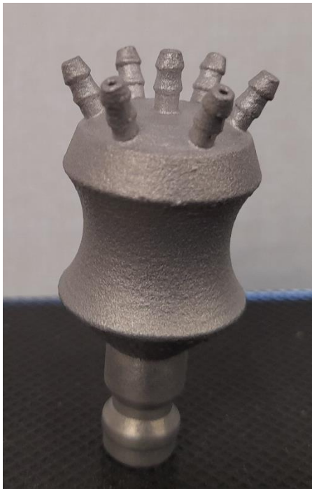
5: Aluminiumbauteil nach Druckprozess (unbearbeitet)
