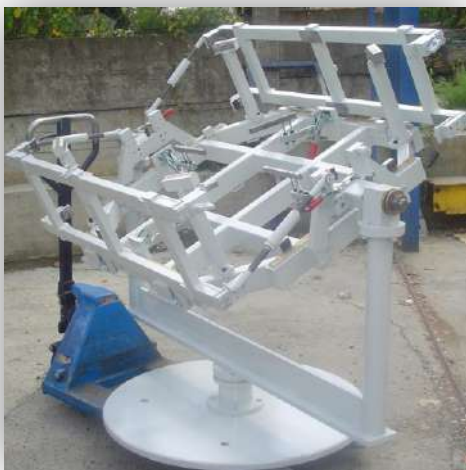
Spannvorrichtung zum Schweißen der BEHÄLTER
