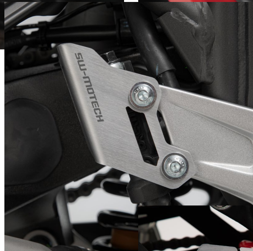
Bremspumpen-Schutz an der Ténéré 700 (rechts) sowie Fersenschutz und Kettenschutz an der Tiger 900 (unten)
