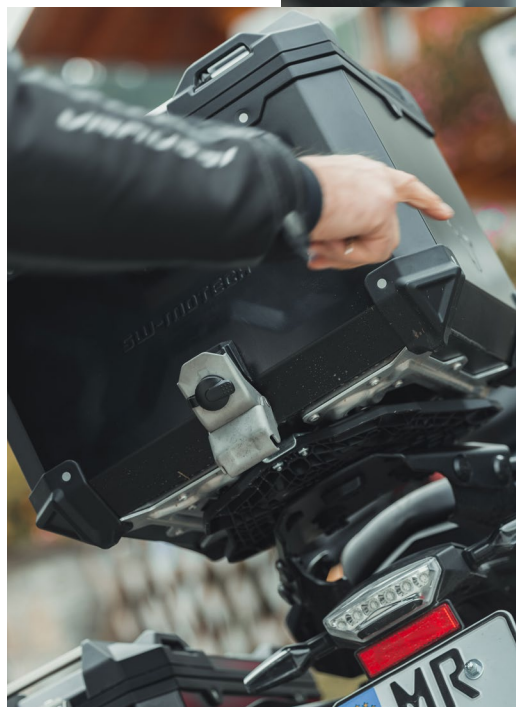
Ein Schloss im Spannverschluss sichert das Topcase vor Diebstahl
