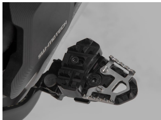
Verbreiterung der Auflagefläche des Fußes
