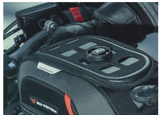
Der T-Lock Halter verbindet mittels einer Drehverriegelung Zusatztaschen mit dem MOLLE-Aufsatz
