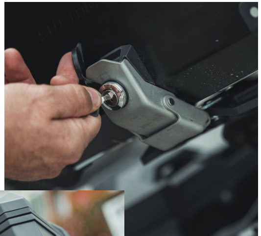
Ein Schloss im Spannverschluss sichert das Topcase vor Diebstahl
