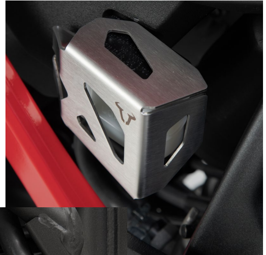
Wasserpumpenschutz an der Ténéré 700 (links) und Bremsflüssigkeitsbehälter-Schutz an der Africa Twin CRF 1100 (unten)
