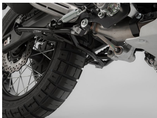
Konstruktion für größtmögliche Schräglagenfreiheit
