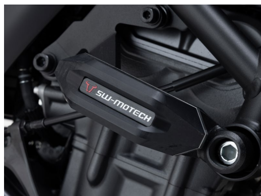
Rahmen Sturzpads – Schutz für den Motor bei Stürzen
