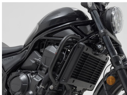
Sturzbügel – Schutz für den Motor bei Umfallen und Stürzen
