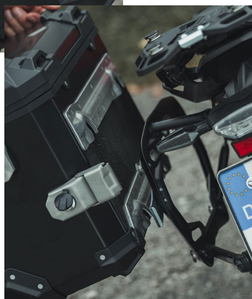
Die Seitenkoffer lassen sich leicht in die vier Haltenocken am Träger einhängen
