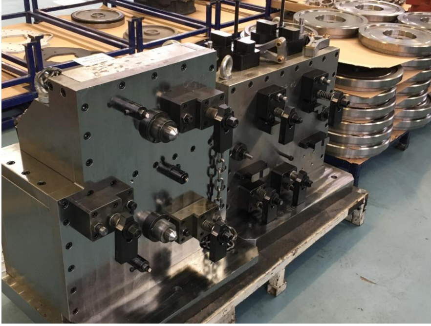
117 hp motor silindir gövdesi işleme fikstürü tasarımı ve imalatı
