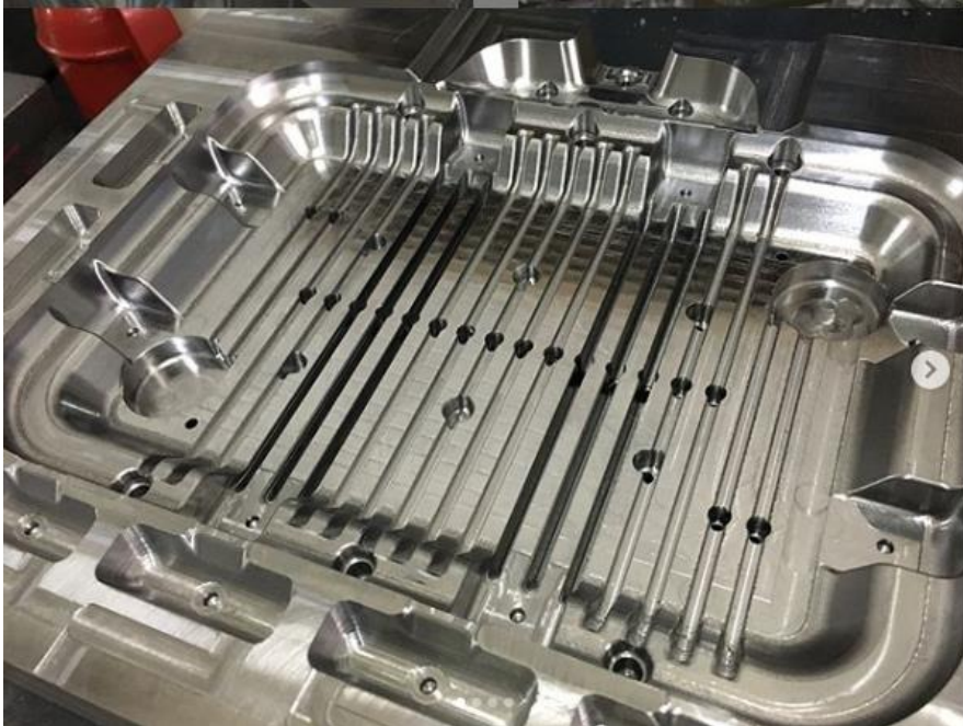
Metal enjeksiyon kalıbı - 1.2343 sıcak iş takım çeliği - 400x320x110
