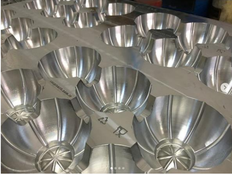
Termoform kalıbı - 5083 Alüminyum - 550 x 320 x 60
