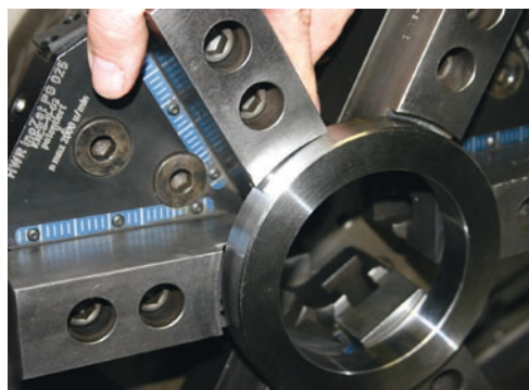
Wirkungsweise: Beim Schließen des Futters (Bild links) drückt sich eine Backe an das Werkstück, während die andere pendelnd anschließt. Dann fahren alle sechs Backen zu (Bild oben).
