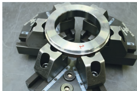
Mit den Pendelbrücken können die Teile mit hohen Haltekräften, aber niedrigen Spanndrücken gespannt werden; die Verformung ist minimal.
