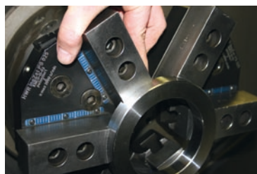
Wirkungsweise: Beim Schließen des Futters (Bild links) drückt sich eine Backe an das Werkstück, während die andere pendelnd anschließt. Dann fahren alle sechs Backen zu (Bild oben).
