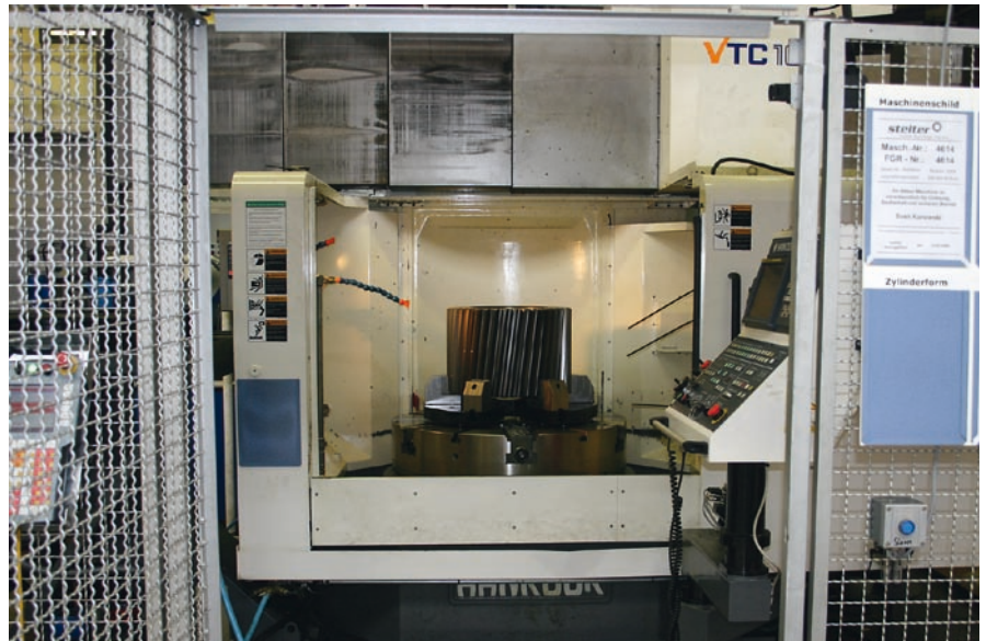
Selbst bei den großen Planetenrädern mit 650 mm Durchmesser und 380 mm Höhe kann das InoZet seine Vorteile ausspielen. Effekt: Die Genauigkeit der Bearbeitung hat sich deutlich erhöht; dadurch wurde eine automatisierte Fertigung prozesssicher möglich.
