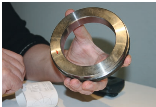
Labile Teile: Bisher mussten die Zahnrad-Rohlinge aus Genauigkeitsgründen in zwei Maschinen gefertigt werden; ein unwirtschaftlicher Prozess.
