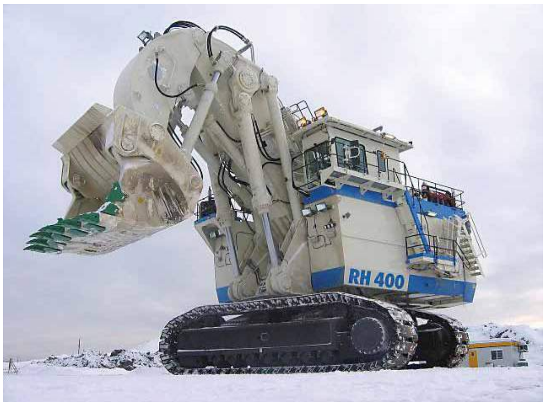
Weltgrößter Hydraulikbagger RH 400 Bagger-schaufel – 43 m 3 /Fahrwerksträger 100 mm Materialstärke Worldwide biggest hydraulic excavator RH 400 excavator shovel – 43 m 3 /bogje girder 100 mm material thickness
