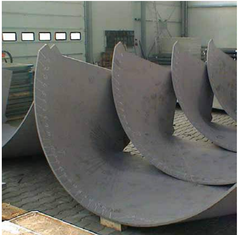
Fundamente für Schiffskrane; Übergang von rund – eckig / Fundaments for shipboard cranes; transition from round – angular
