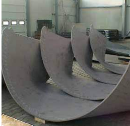
Schiffskranfundamente – Übergang von rund auf eckig Shipboard cranes fundaments – transition from round to angular
