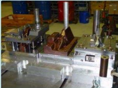
Umformwerkzeug mit Stanzeinheit
