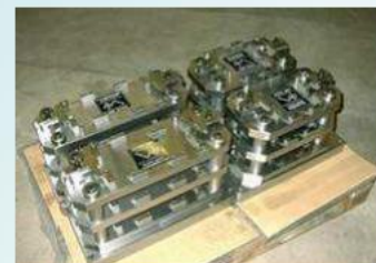
Fräsvorrichtung 3 Ebenen , Toleranz \pm 0,01
