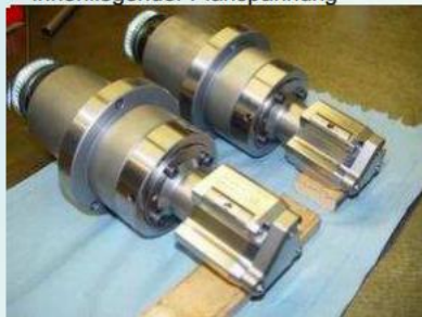
Kontrolldorn, 3-Backen, Rundlauf 0,008 mm
