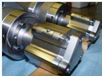
Spannfutter zum Bearbeiten verzahnter Werkstücke mit Schwenk-Planspannung
