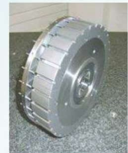
Schleifcarrier für Wellenbearbeitung
