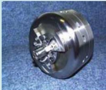
Membranspannfutter mit innenliegender Planspannung
