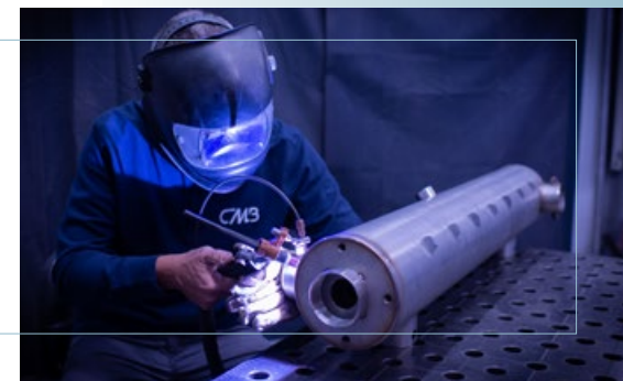
Area di saldatura composta da due banchi da lavoro Siegmund e sistema di serraggio flessibile
