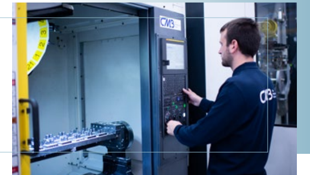
Fanuc Robodril mandrino ALPHA D21-LiB5 10k/10.000 rpm con 4 assi per operazioni di fresatura, foratura e filettatura
