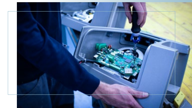
Area di assemblaggio e prova preparata per l'assemblaggio di componenti elettronici con monitoraggio periodico della resistenza a terra dei dispositivi in aree di lavoro ESD specificatamente ideate
