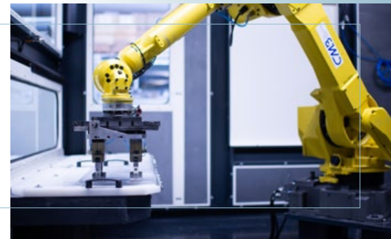
ARCOS-FANUC Roboteranlage zum Bürsten, Schleifen, Satinieren und Polieren
