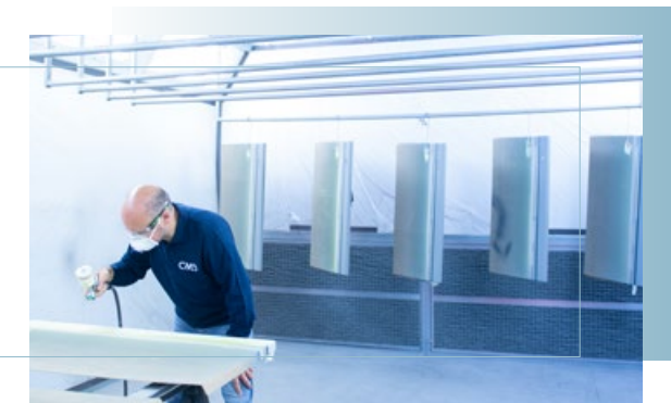
Lackierkabine zum Sprühlackieren mit Farben auf Wasser- oder Lösungsmittelbasis
