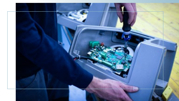
Montage und Prüfbereich ausgestattet für die Montage elektronischer Komponenten mit regelmäßiger Überprüfung des Bodenwiderstands der Geräte in speziell entwickelten, ESD-geschützten Arbeitsbereichen
