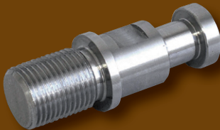
Sonderschraube Ø 9.6 x 139.5 mm lg. aus 42CrMo4V
