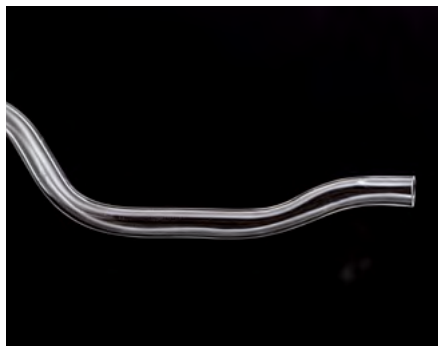
Verformtes PMMA Rohr
