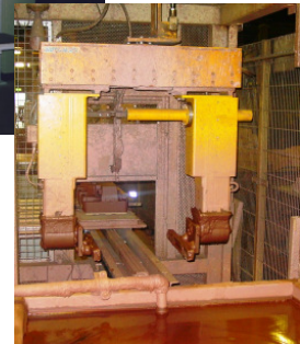
Handhabungsanlage zum Tauchen von Zylinderkopf-Kernen
