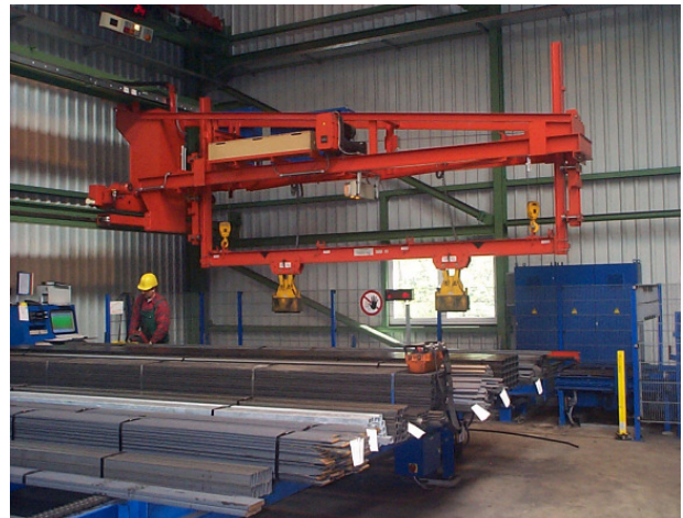
Konsolkommissionierkran mit Magnethebeeinrichtung
