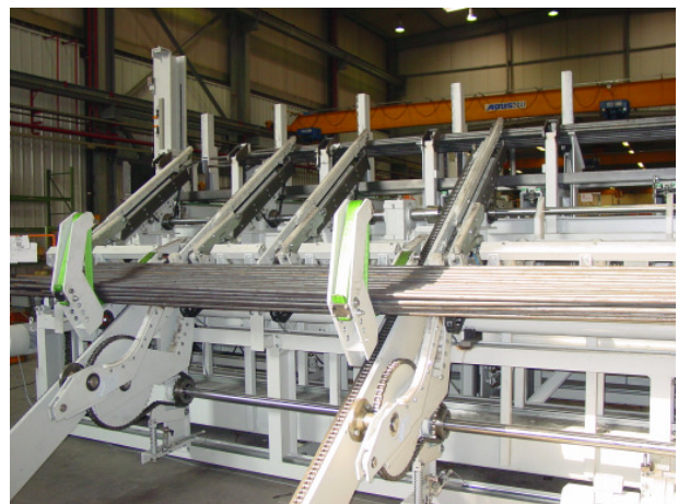
Bundformer mit Schrägaufzug zur Waage
