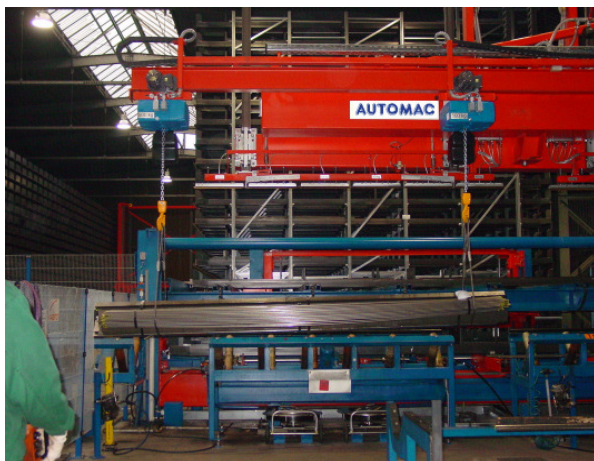
Konsolkommissionierkran mit Tandemkettenzugbetrieb und Vakuumhebetaverse
