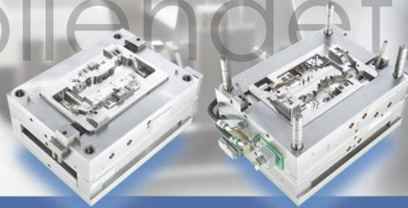
2-fach Spritzgießwerkzeug mit Heißkanal, 2 Schiebern, 2 Kernzügen und umspritzten Metalleinlegebuchsen
