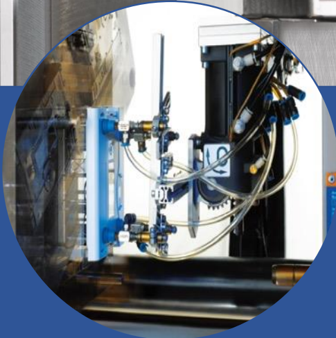
2-Komponenten-Fertigung mit Drehteller-Technik
