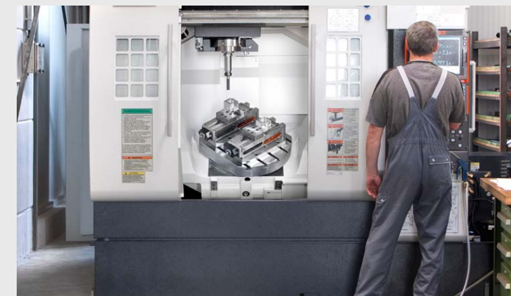
5-Achsen-Bearbeitung: Hohe Genauigkeit in einer Spannung
