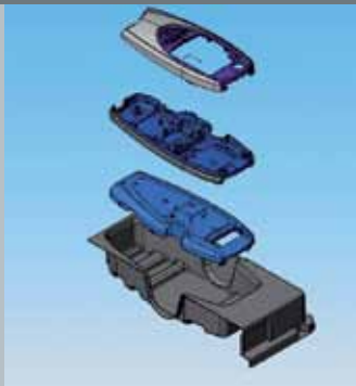
Konstruktiver Lösungsvorschlag einer Nestaufnahme – passend für Ober- und Unterteile
